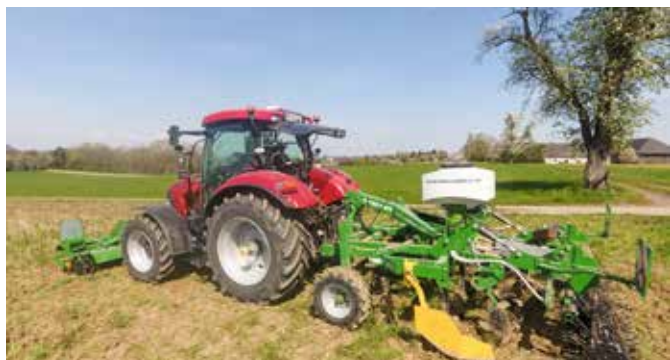
Sogenannte Exaktgrubber sind für die „ultraflache Bearbeitung“ mit Tiefenführungsräder und Gänsefußscharen ausgestattet. Bei angebauten Geräten kann dabei auf das Nachlaufgerät verzichtet werden bzw. mit Striegelwerkzeugen ersetzt werden.
