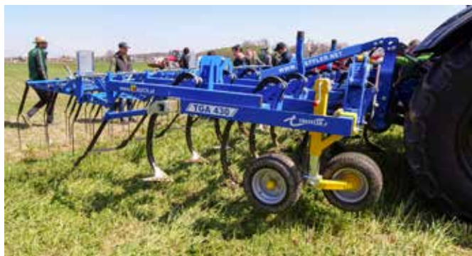
Sogenannte Exaktgrubber sind für die „ultraflache Bearbeitung“ mit Tiefenführungsräder und Gänsefußscharen ausgestattet. Bei angebauten Geräten kann dabei auf das Nachlaufgerät verzichtet werden bzw. mit Striegelwerkzeugen ersetzt werden.
