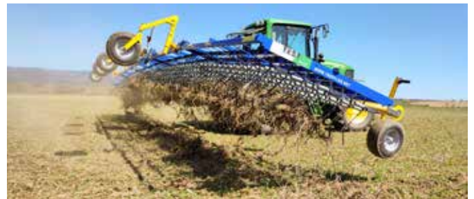
Der Einsatz von Hackstriegeln ist bei größeren Mulchmengen meist nicht möglich
