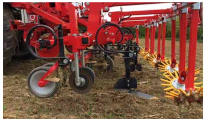
Die Ausstattung mit Räumscheiben vor den Winkelscharen reduziert die Gefahr des Verstopfens. Im Zwischenreihenbereich sind wenige, breite Scharen angeordnet, um möglichst hohen Durchgang zu gewährleisten. Foto: Martin Fischl
