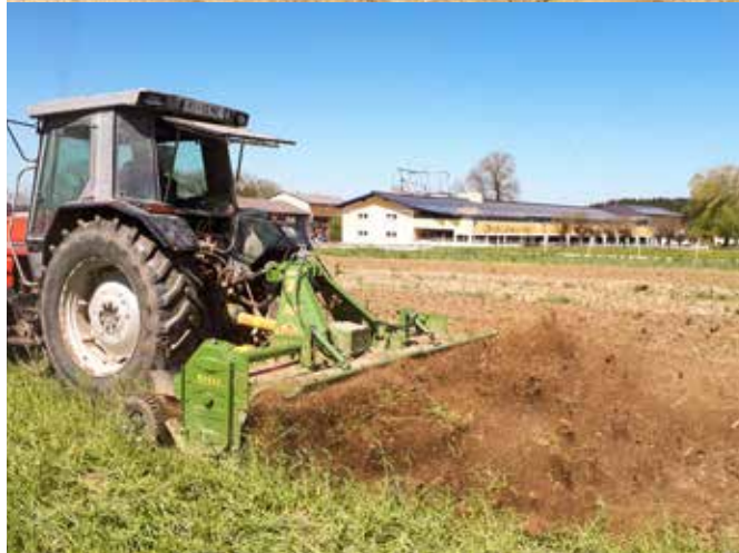
Ackerfräsen arbeiten sehr intensiv und sind wenig schlagkräftig bei der Bearbeitung winterharter Begrünungen.
