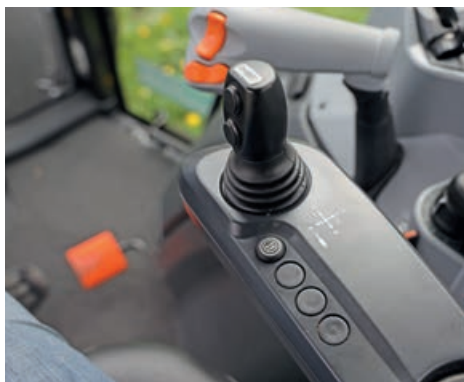
Mit dem optionalen Hydraulik-Joystick in der Armlehne lässt sich z.B. der Frontlader gut bedienen.
