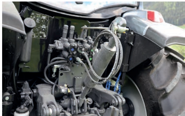
Alle drei doppelwirkenden Steuergeräte im Heck rasten ein und haben eine Schwimmstellung.
