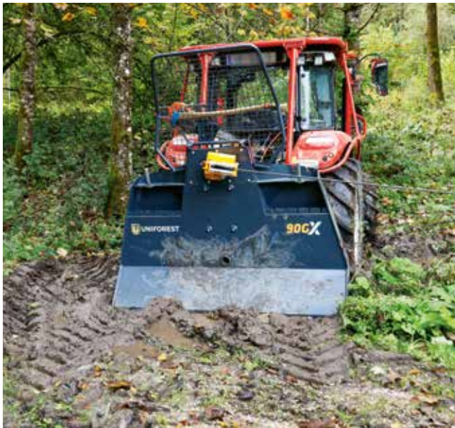
Laut Hersteller ist der seitliche Zuzug beidseitig auf 30° begrenzt, aus praktischer Sicht wäre ein größerer Bereich sinnvoll.
