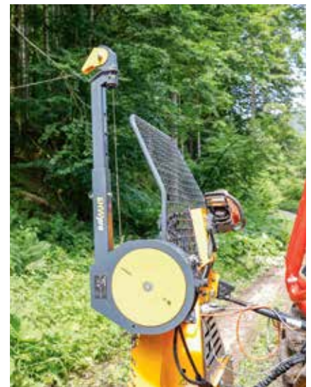
Hilfsseilwinde mit guter Höhenverstellung und 360° schwenkbarem Seileinlauf.
