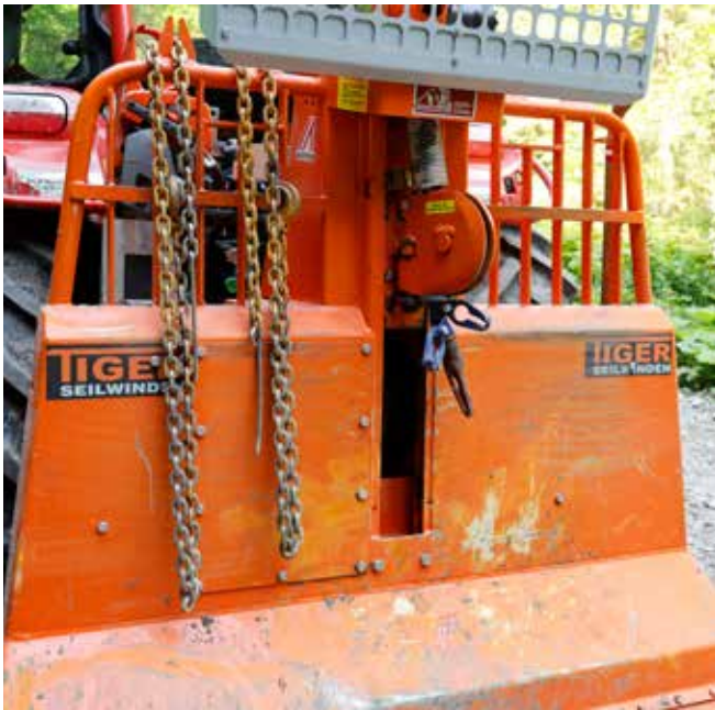
Durch die hydraulisch stufenlos verstellbare Umlenkrolle wird auch beim seitlichen Zuzug eine hohe Windenstabilität erreicht.
