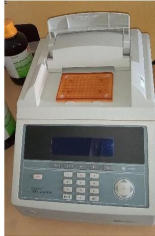
Abb. 9: Thermocycler – Gerät für die PCR Amplifikation - mehrfache Vervielfältigung einer bestimmten DNA-Region
