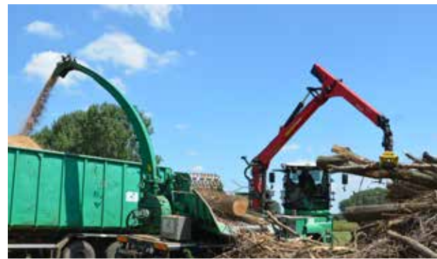
Gut vorgetrocknete Biomasse mit hohem Anteil an Stammholz eignet sich am besten für qualitativ hochwertige Hackschnitzel. Bildquelle: Jenz.
