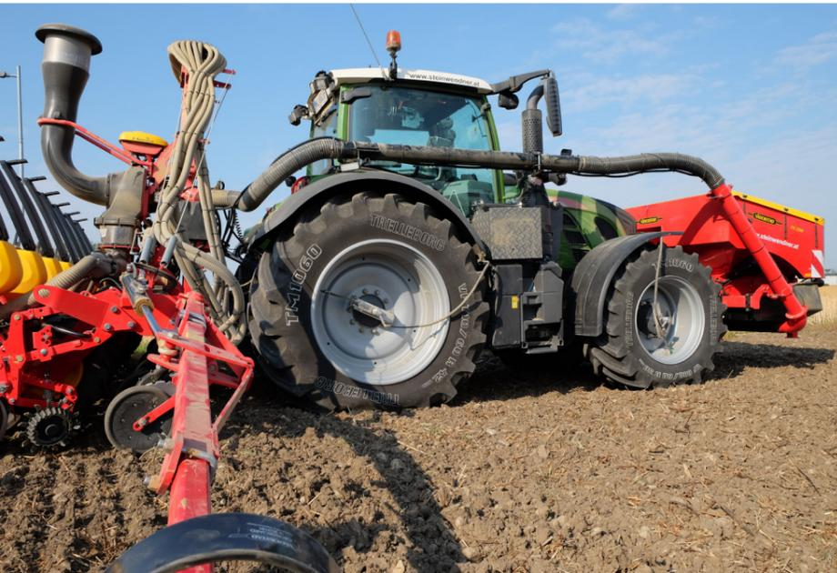
△ Bei der Sämaschine kann jedes Säelement einzeln elektrisch angesteuert werden.
