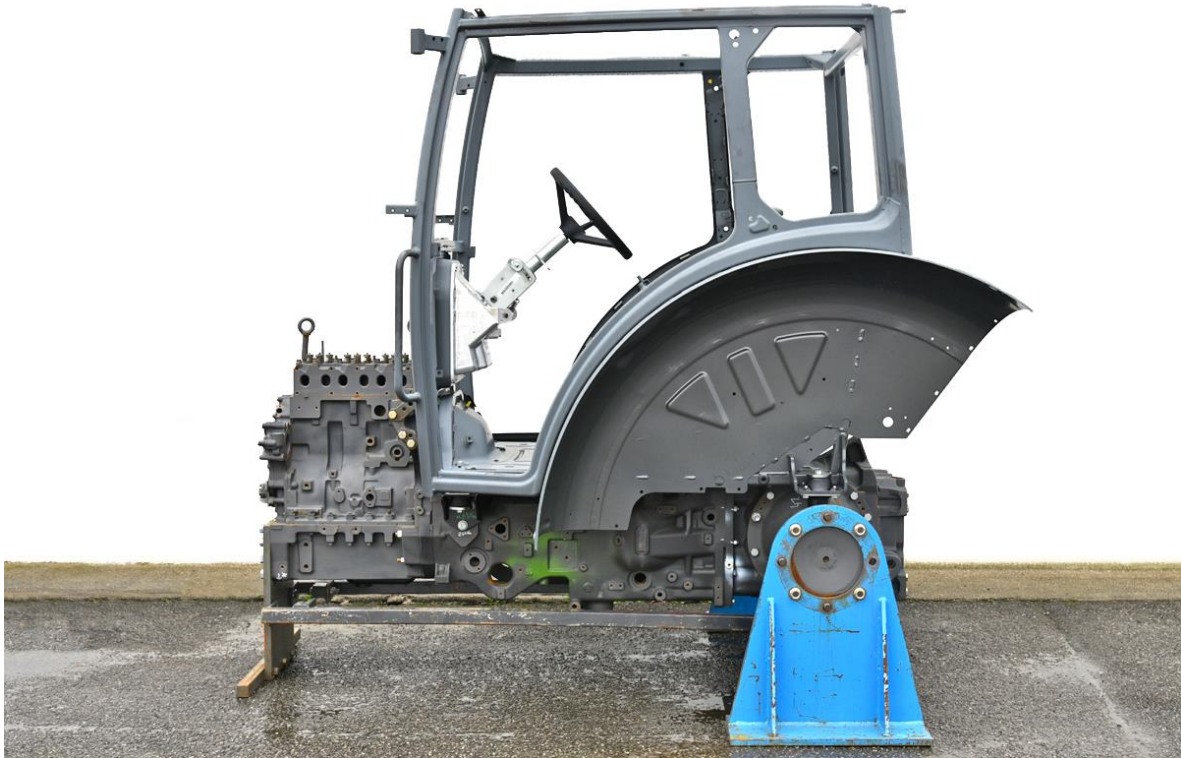
Abbildung 7: 6-post Frame für einen Standardtraktor (Quelle: FJ-BLT Wieselburg)
