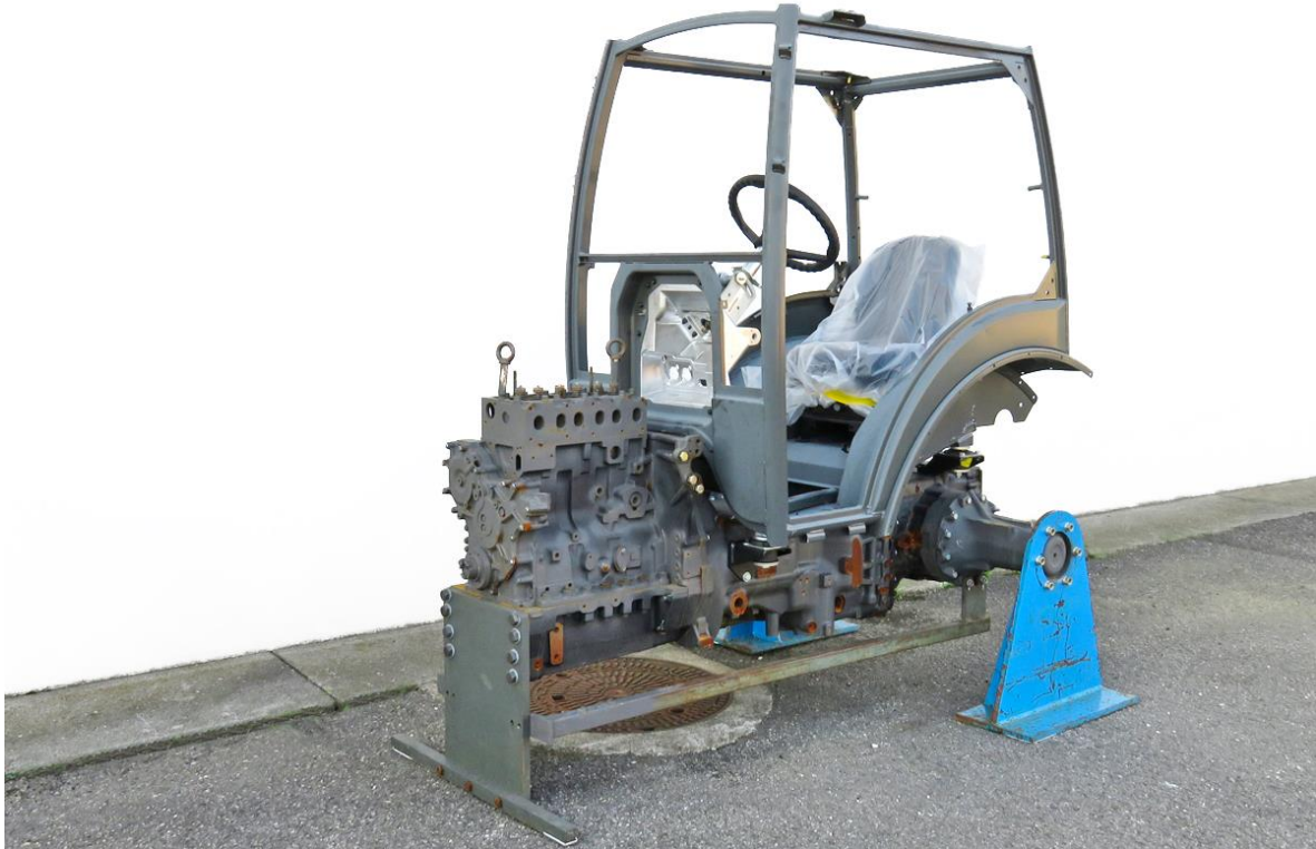
Abbildung 8: 4-post Frame für einen Schmalspurtraktor (Quelle: FJ-BLT Wieselburg)
