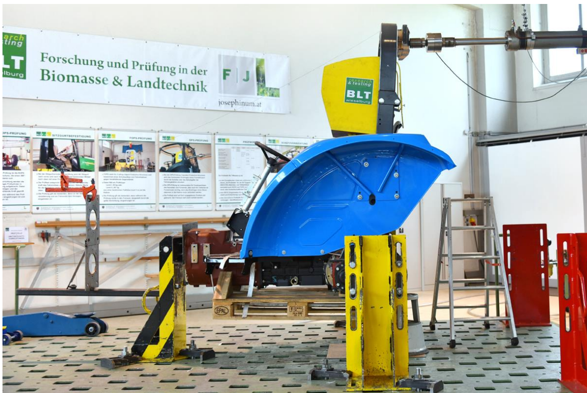
Abbildung 4: Prüfanordnung – ROPS test arrangement before the test an FJ-BLT Wieselburg (Quelle: FJ-BLT Wieselburg)
