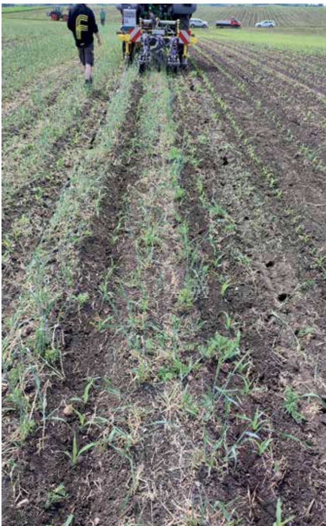
Abb. 2: Prototyp einer In-Row Hacke der Fa. Feldklasse (DE) mit einem KI-gestützten Kamerasystem der Fa. Ullmann (CZ)
