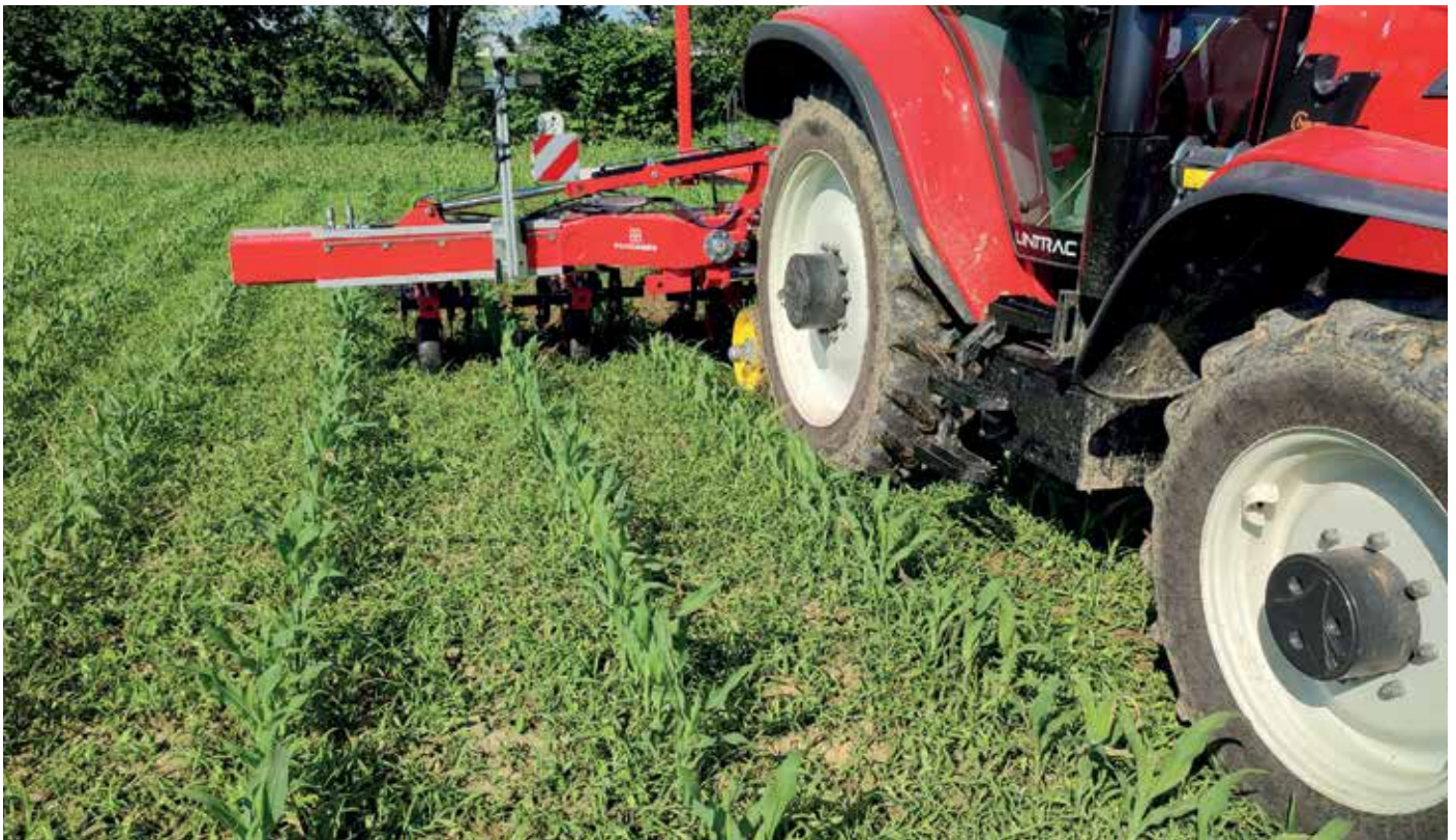
Abb. 1: Systeme, die mehrere Reihen auswerten, arbeiten auch unter schwierigen Bedingungen meist sehr zuverlässig.
