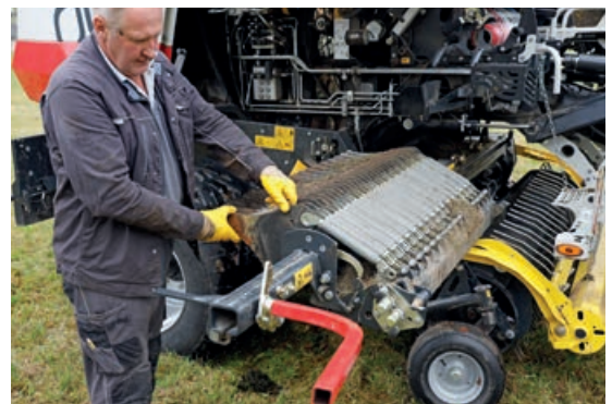
Einfacher und sicherer Messerwechsel dank ausziehbarem Schneidwerk.
