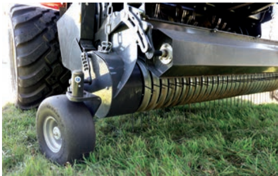
Die nachlaufgelenkten Pendeltasträder waren bei der Kuhn-Pressen aus Vollgummi.
