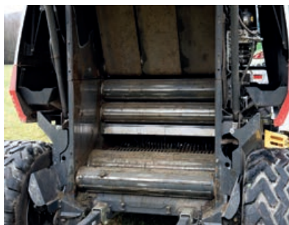
Die Presskammer der Impress hat vier Starterwalzen und drei Riemen.
