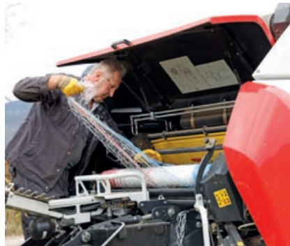
Die Netzbindung muss bei Futterwechsel oder Temperaturschwankungen öfters nachjustiert werden.
