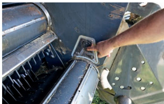
Zwei Feuchtigkeitssensoren passen den Pressdruck an das Erntegut und die Bedingungen automatisch an.
