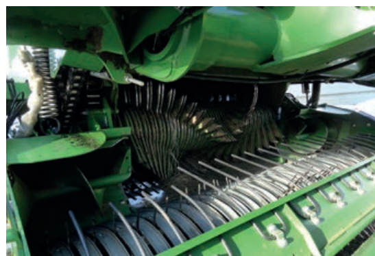
Der Rotor verfügt über in drei Reihen spiralförmig angeordnete Doppelzinken und hat seitlich zwei Zuführschnecken.
