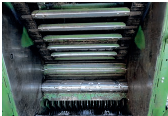
Der Stabgurtförderer wird über große, breite Umlenk- und Antriebsräder angetrieben.
