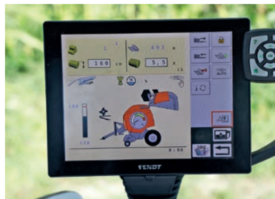
Die ISOBUS-Bedienung mit dem Fendt Traktorterminal funktionierte gut und gab keine Rätsel auf.
