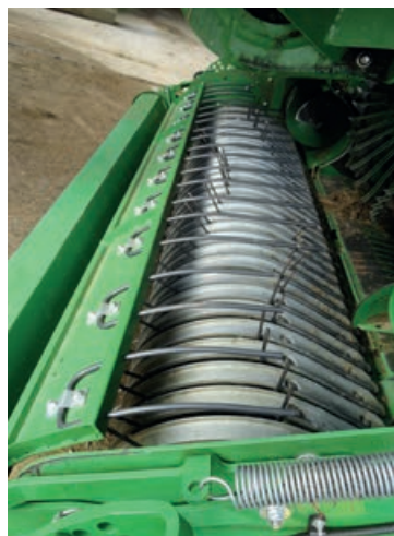
Der Stabgurtförderer wird über große, breite Umlenk- und Antriebsräder angetrieben.
