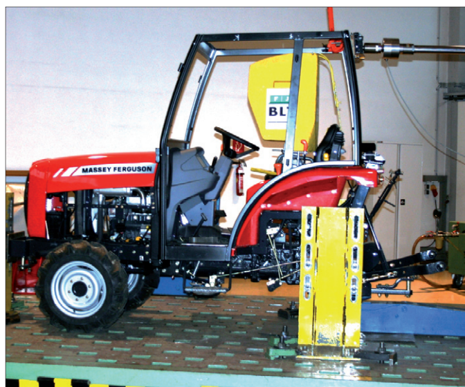
Heute wird vor allem mithilfe von statischen Tests auf die Einhaltung der Sicherheitsvorschriften geprüft.
