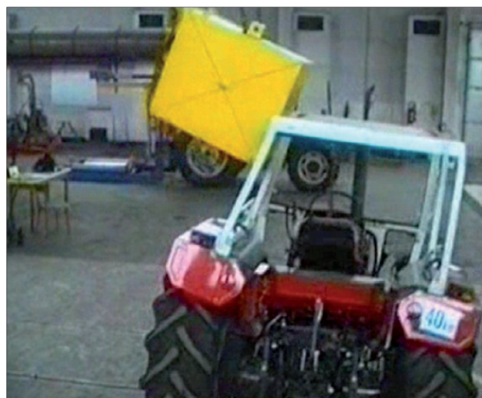
Bei der dynamischen ROPS-Prüfung mit Pendelschlaggewicht ist die verfügbare Schlagenergie begrenzt.
