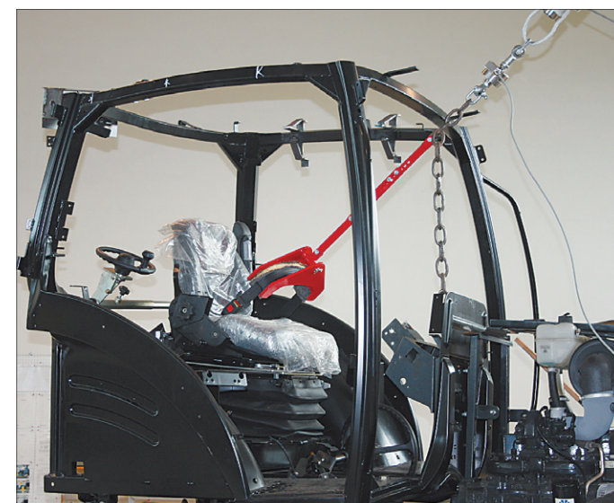
Die Sitzgurterankerungsprüfung im Rahmen der statischen Tests ist derzeit nicht vorgeschrieben.
