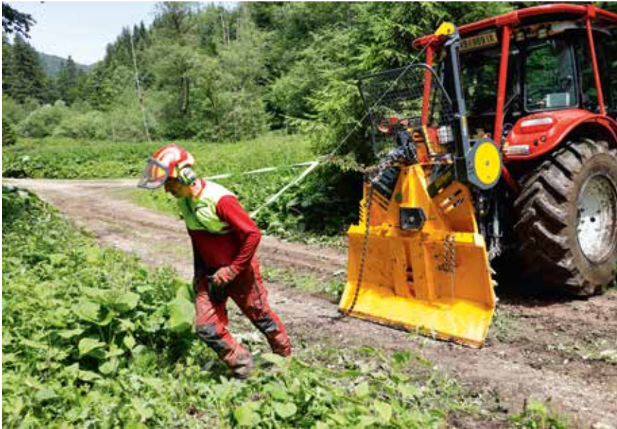
Hilfsseilwinden liegen im Trend und erleichtern die Rückarbeit vor allem im unwegsamem Gelände. Diese stecken bei einigen Herstellern noch in der Entwicklungsphase.
