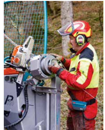
Mast und Trommel lassen sich mit wenigen Handgriffen ablegen.
