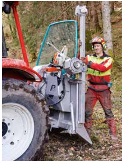
Die seitlich montierte Hilfsseilwinde lässt sich auch einfach nachrüsten.
