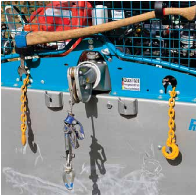
Zwei belastbare Kettenfallen vorne, Kettenfallen für je zwei Ketten in die Kisten nach hinten.
