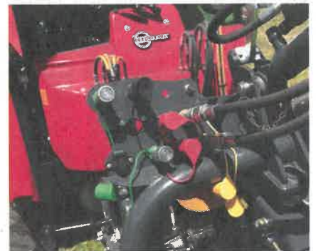
Flachdichtende Hydraulikanschlüsse im Heck und in Front.
