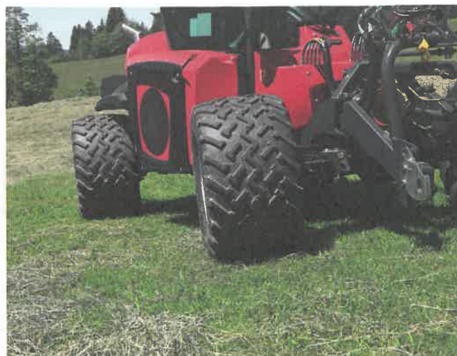
Große Räder und vier Lenkungsarten: 2-Rad-, 4-Rad-, Hundegang- oder manuelle Lenkung. Die Driftlenkung ist optional.
