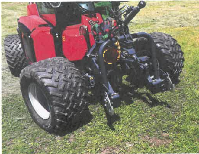
Seitenvershub: Die Parallelogramm-Verschiebung der Frontunterlenker ermöglicht viel Freiraum für die Gelenkwelle.
