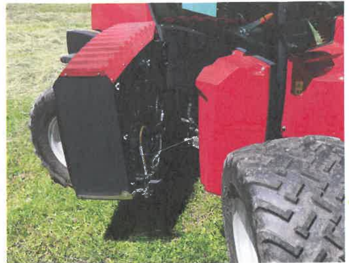
Das Kühlerpaket rechts von der Kabine lässt sich seitlich wegklappen. Per Knopfdruck bläst der Wendelüfter den Schmutz aus den Kühlrippen.
