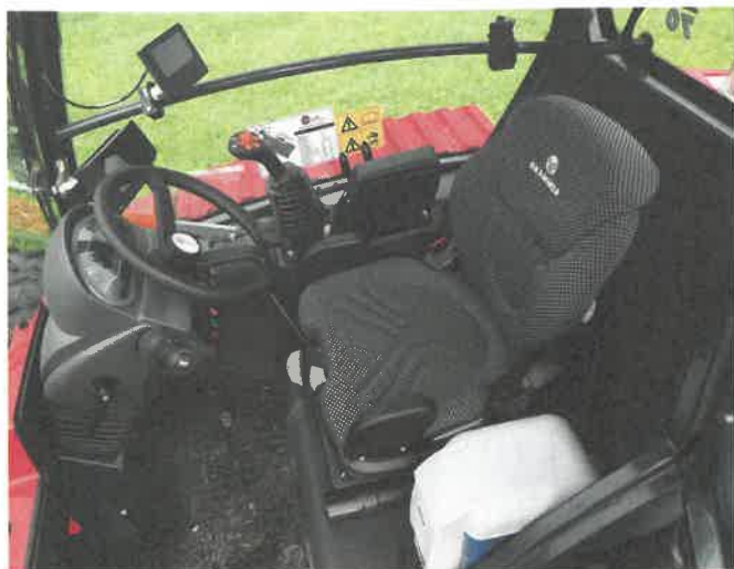
Das Platzangebot in der Kabine ist gut. Rechts vom Fahrer befinden sich das Bedienterminal, der Kamera-Bildschirm und der Joystick.
