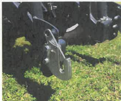
Vorne lassen sich die Unterlenkerfanghaken von Kat. I auf Kat. II umschrauben.
