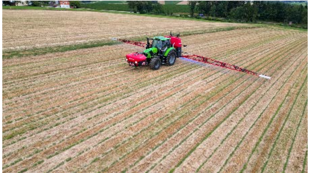
Die Kombination von Fronttank und Anbaufeldspritze hatte im Praxiseinsatz viele Vorteile.
