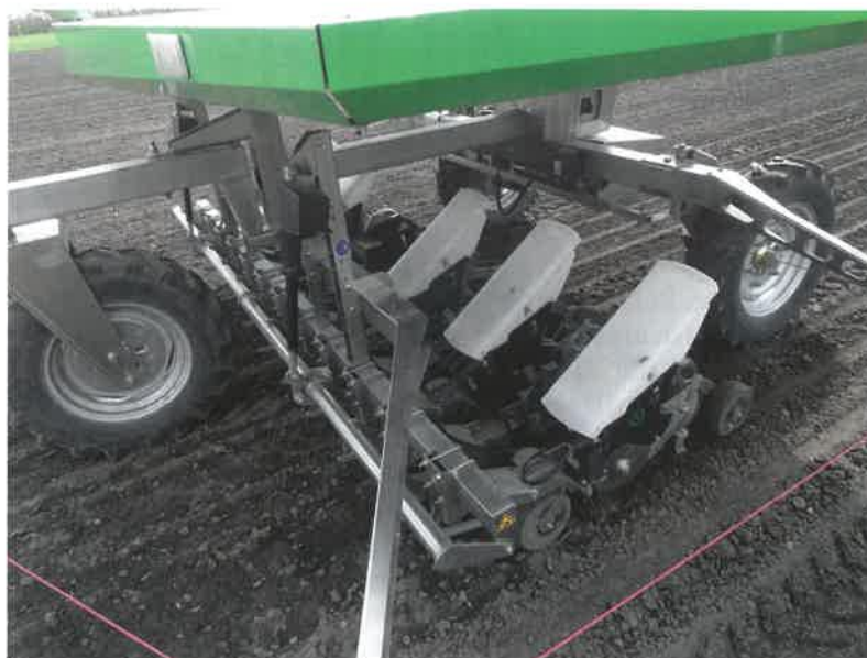
Abb. 2: Der mit Solarkraft betriebene Feldroboter zeichnet die Position des abgelegten Saatgutes auf und steuert danach die In-Row-Hackwerkzeuge beim Hacken.
