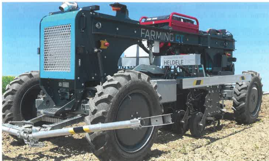
Abb. 3: Benzin-elektrischer Feldroboter, der über die KI-gestützte Bildanalyse die Kulturpflanzen erkennt und damit das In-Row-Hackwerkzeug steuert
