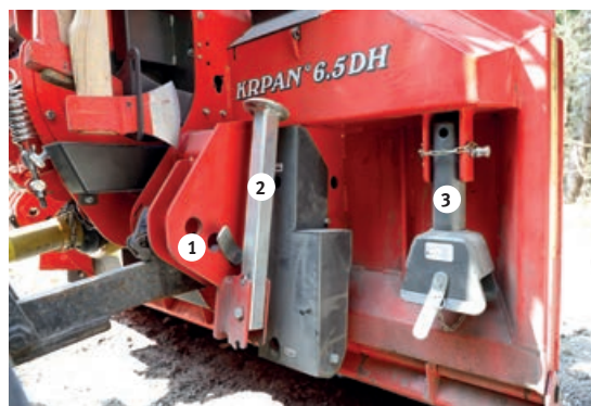
(1) Drei Unterlenker-Anbaupositionen, (2) werkzeuglos klappbare Stützfüße und (3) Zugmaul in Parkposition.
