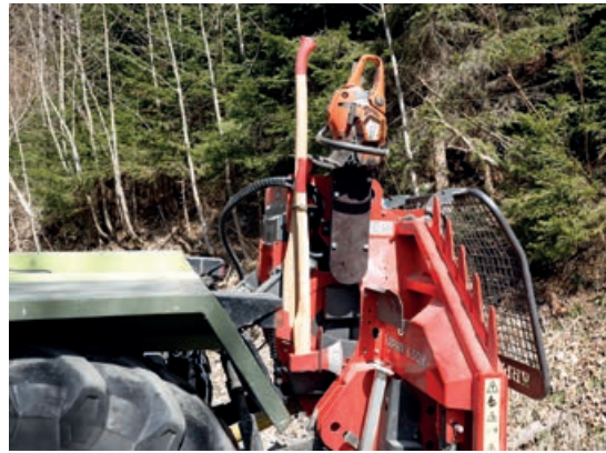
Die Motorsäge ist aus der hoch angeordneten Halterung schwer zu entnehmen.
