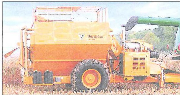
Der gezogene Maisspindelernter mit eigenem Motor separiert und bunkert die Spindeln bis zum Überladen. FOTO: BLT WIESELBURG, WERKBILD
