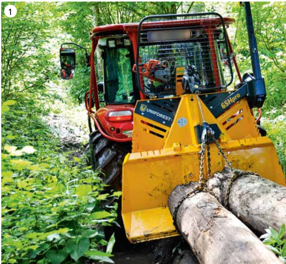
1) Die Uniforest 65HPro steht stabil, das Seil kann auch noch tiefer eingelegt werden. 2) Ein zuverlässiger Endabschalter an der oberen Seileinlaufrolle. 3) Die seitlichen Staufächer sind gut erreichbar, verschmutzen aber leicht.
