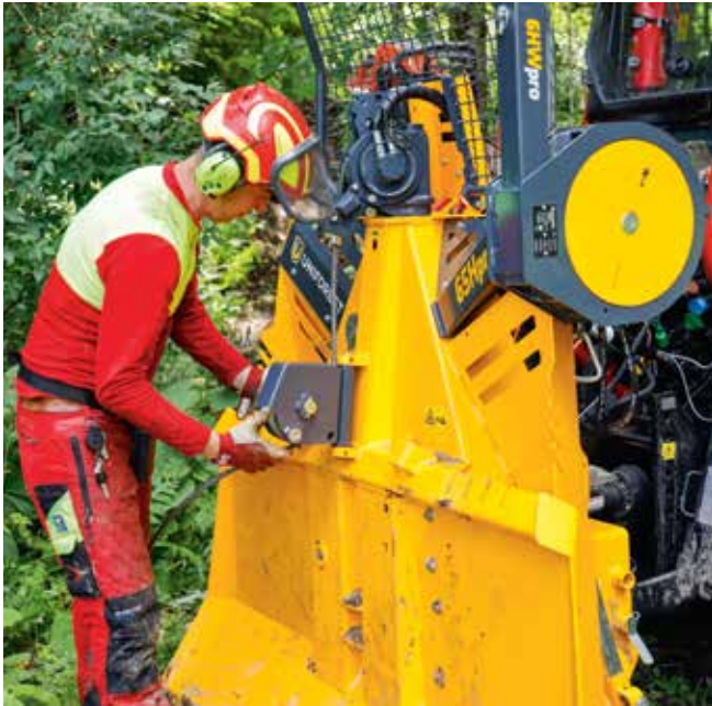
Bei Nichtgebrauch hält ein Magnet die untere Seileinlaufrolle, das Seil wird zusätzlich verriegelt.
