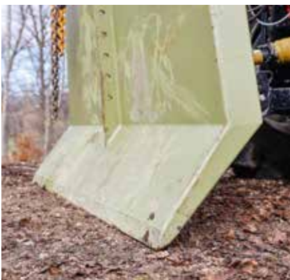
Verschiedene Rückeschilder (v. o.): Schlang&Reichard mit hydraulischer Verstellung, Tiger mit aufgeschraubter Verschleißschiene, das Scharfkantige von Königswieser mit kurzer unterer Schräge, und das glatte Rückeschild von Holzkecht mit langer unterer Schräge.
