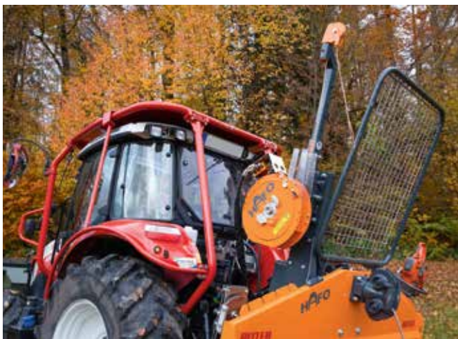
Zwei sehr unterschiedlich positionierte Hilfsseilwinden: Die HAFO links im Bild ist hier hoch montiert, lässt sich aber an verschiedenen Positionen anbringen. Die seitlich tief positionierte Tajfun Hilfswinde – rechtes Bild – schränkt die Arbeit der Hauptwinde stark ein.
