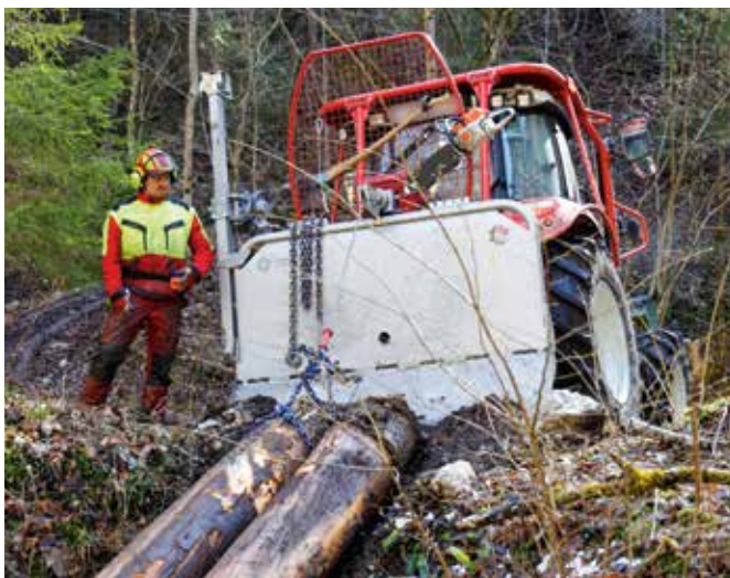
Kettenrad- oder Getriebewinde? Für bäuerliche Betriebe mit moderatem Einsatz reicht in der Regel eine Kettenradwinde.
