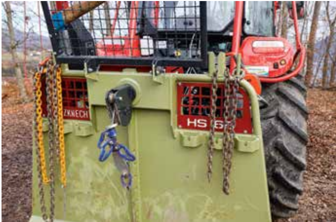
Die Bruchlast von Zugseil, Anschlagmittel, Seilgleiter, Umlenkrollen, Rundschlingen und Schäkeln muss auf die jeweilige Winde abgestimmt sein.
