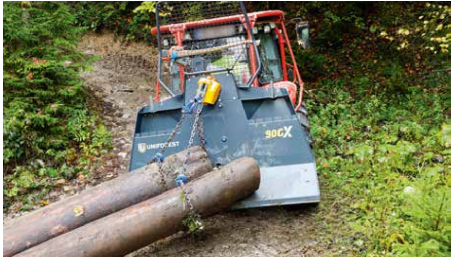
Die Uniforest 90GX war die stärkste Winde in unserer Testreihe. Sie zieht laut BLT-Messung 77 kN am Kern.
