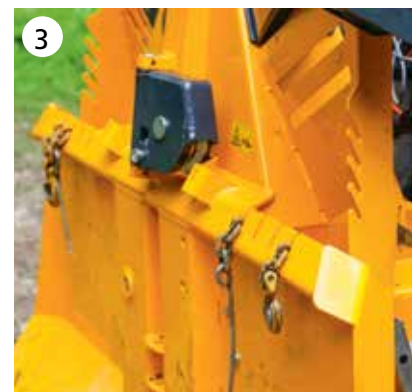
1) Die Uniforest 65HPro steht stabil, das Seil kann auch noch tiefer eingelegt werden. 2) Ein zuverlässiger Endabschalter an der oberen Seileinlaufrolle. 3) Die seitlichen Staufächer sind gut erreichbar, verschmutzen aber leicht.
