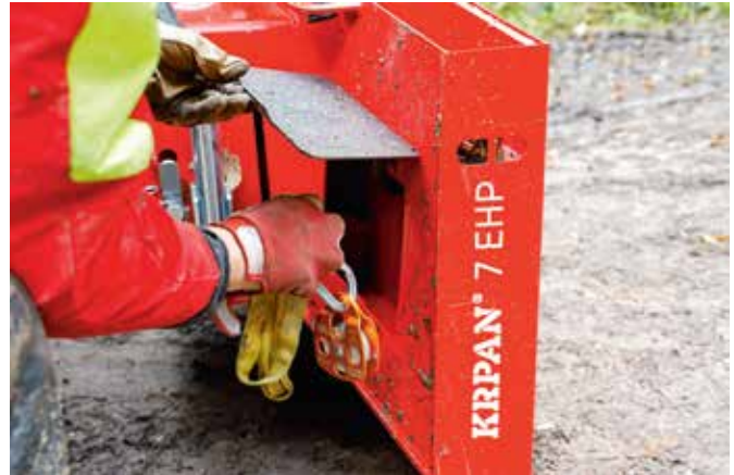
Die Bruchlast von Zugseil, Anschlagmittel, Seilgleiter, Umlenkrollen, Rundschlingen und Schäkeln muss auf die jeweilige Winde abgestimmt sein.
