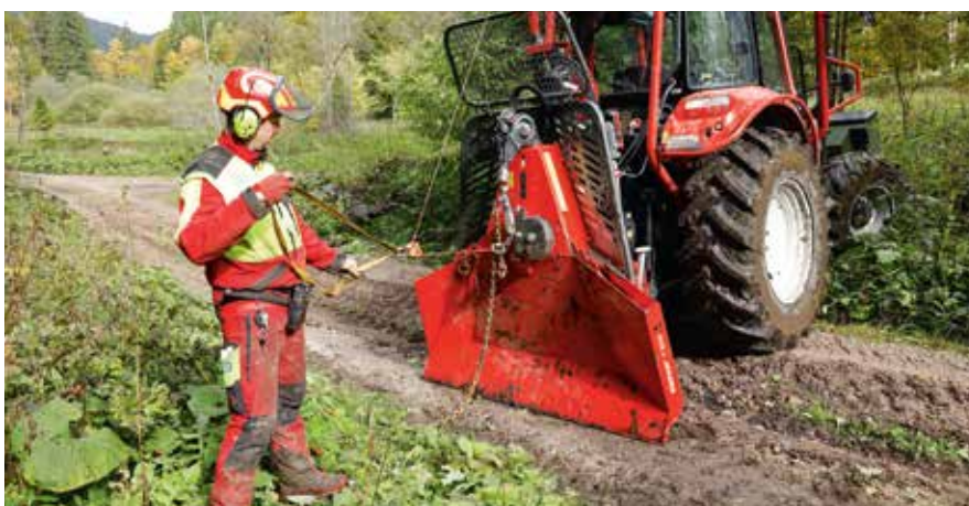
Eine Hilfswinde kann die Arbeit vereinfachen. Die Unterschiede zwischen den Herstellern in der Handhabung sind groß.
