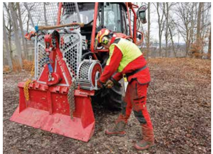
Zwei sehr unterschiedlich positionierte Hilfsseilwinden: Die HAFO links im Bild ist hier hoch montiert, lässt sich aber an verschiedenen Positionen anbringen. Die seitlich tief positionierte Tajfun Hilfswinde – rechtes Bild – schränkt die Arbeit der Hauptwinde stark ein.
