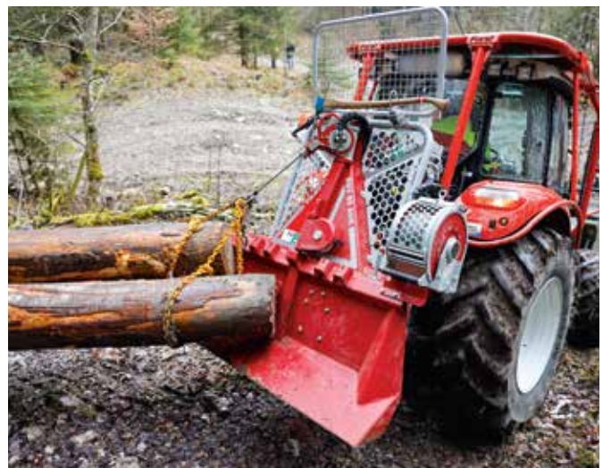
Kettenrad- oder Getriebewinde? Für bäuerliche Betriebe mit moderatem Einsatz reicht in der Regel eine Kettenradwinde.
