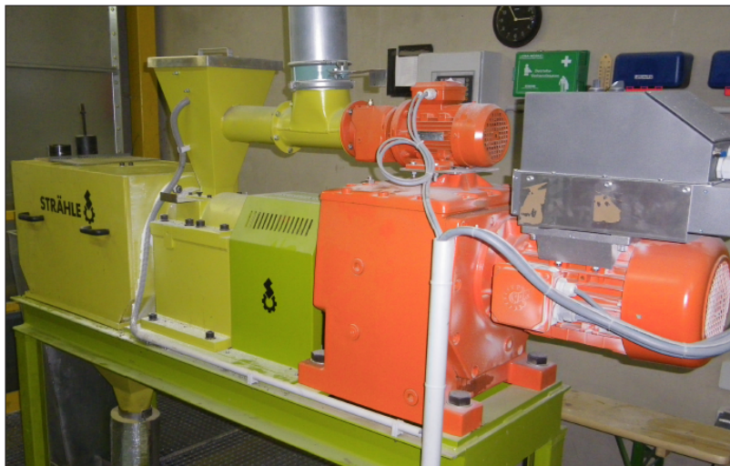
Mit solchen kleineren Ölpresen können regional erzeugte Ölsaaten dezentral verarbeitet werden.
