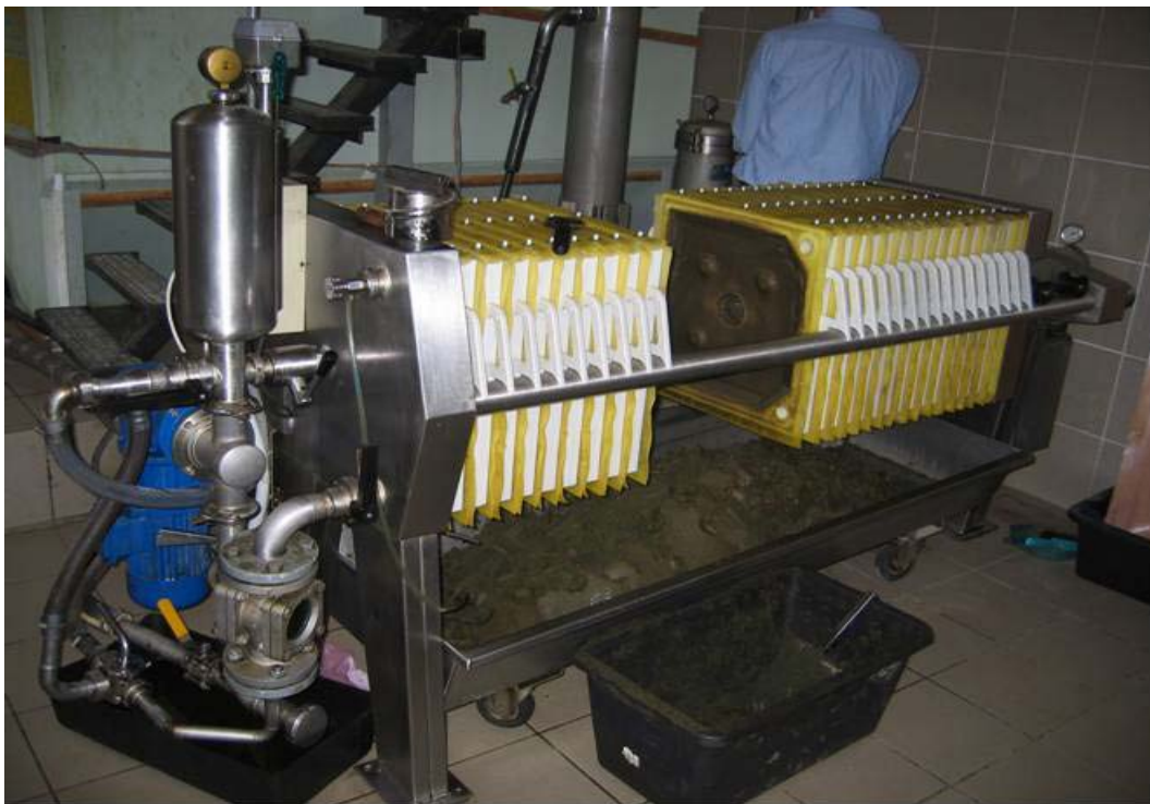
Abbildung 8: Plattenfilter für die Reinigung geöffnet
