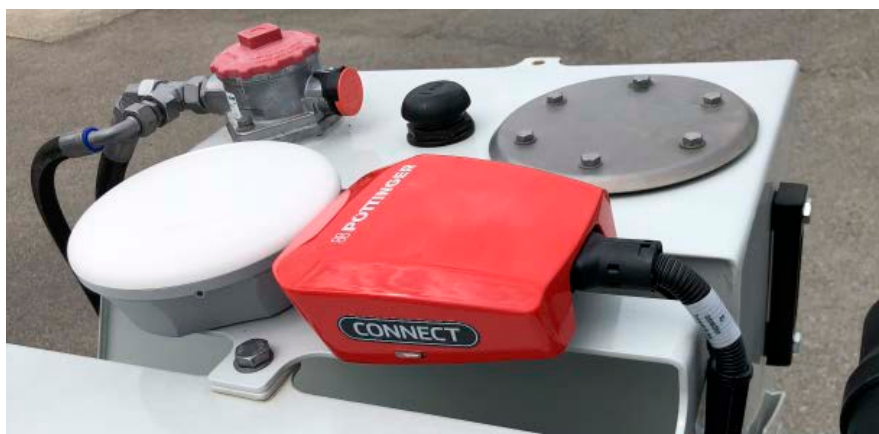
Unscheinbar am Schwader montiert: Die Hardware von Pöttinger Connect (rot) und optional ein externer GNSS-Empfänger (weiß).
