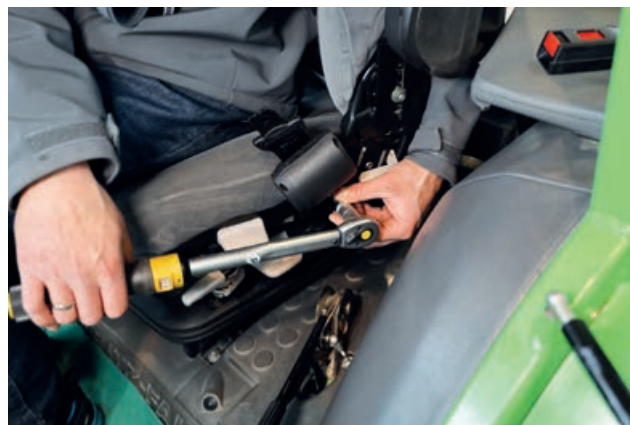
Ein Beckengurt ist einfach an den bereits am Sitz vorhandenen Gewindebohrungen montierbar.
