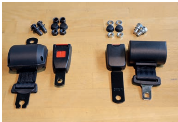
Zwei Nachrüstsätze für einen Beckengurt: links sitzspezifisch vom Sitzhersteller, rechts eine hochwertige Universallösung.
