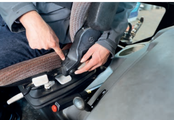
Für diesen Sitz ist eine Nachrüstung möglich. An den Sollbruchstellen lässt sich die Kunststoffabdeckung aussparen.
