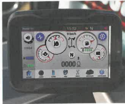
7-Zoll-Touch-Display mit Jobmanager, Freisprecheinrichtung und Bluetooth-Radio.
