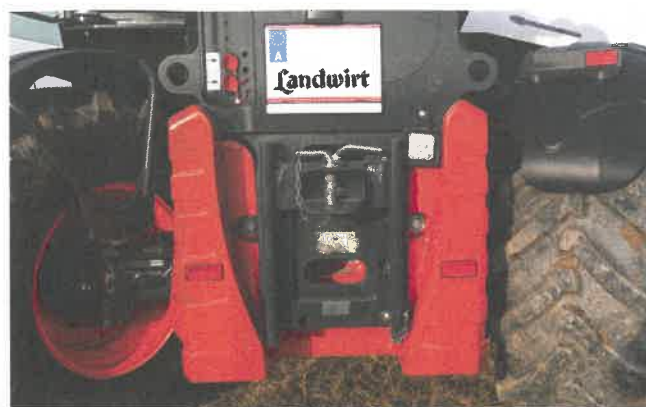
Mit den angeschraubten Heckgewichten (Option) lässt sich die Standfestigkeit verbessern.
