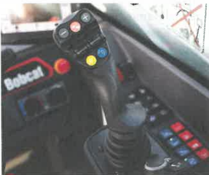
Joystick mit Schaufel-Rüttelbewegung und -Schwimmsteuerung.
