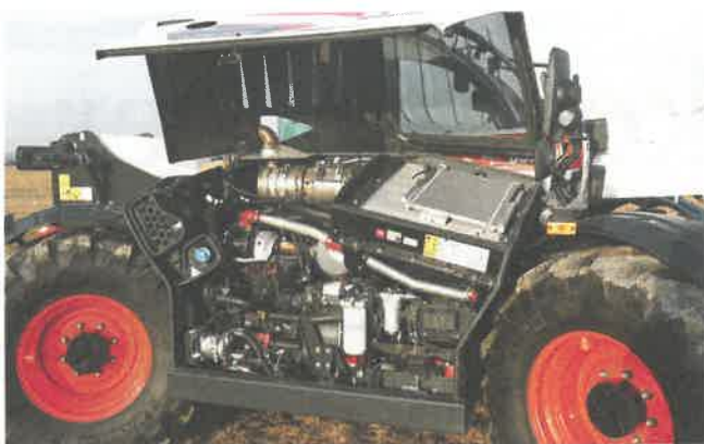
Der Vierzylinder-Diesel aus der hauseigenen Motorenschmiede leistet 101 kW/137 PS.
