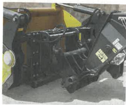
Werkzeugschnellwechsel mit automatischer Verriegelung über Stickstoffblase.
