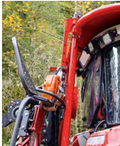
Die hohe Position der Hilfsseilwinde führt zu einer niedrigen Aushubhöhe.
