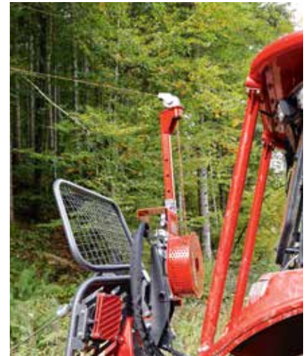
Das Seil ist leicht ausziehen, erst bei höherem Tempo wird es gebremst.
