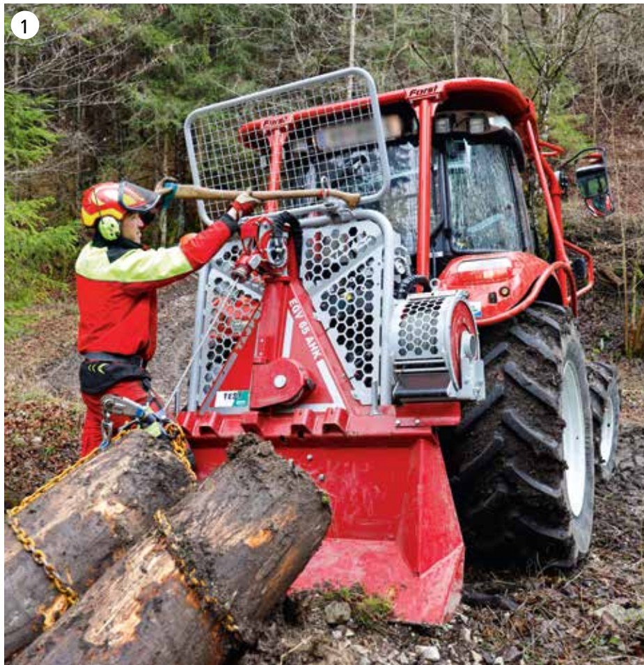
1) Die Standfestigkeit durch den niedrigen Schwerpunkt lässt sich mit der unteren Umlenkrolle nochmals erhöhen. 2) Für einen schnellen Seilwechsel lässt sich die Anpressrolle einfach mechanisch abheben. 3) Der IMET-Funk überzeugt mit einfacher Bedienung und hoher Reichweite.
