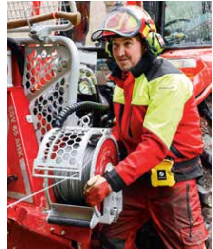
Die Hilfsseilwinde lässt sich mit einer Knarre von 0–100° verdrehen.
