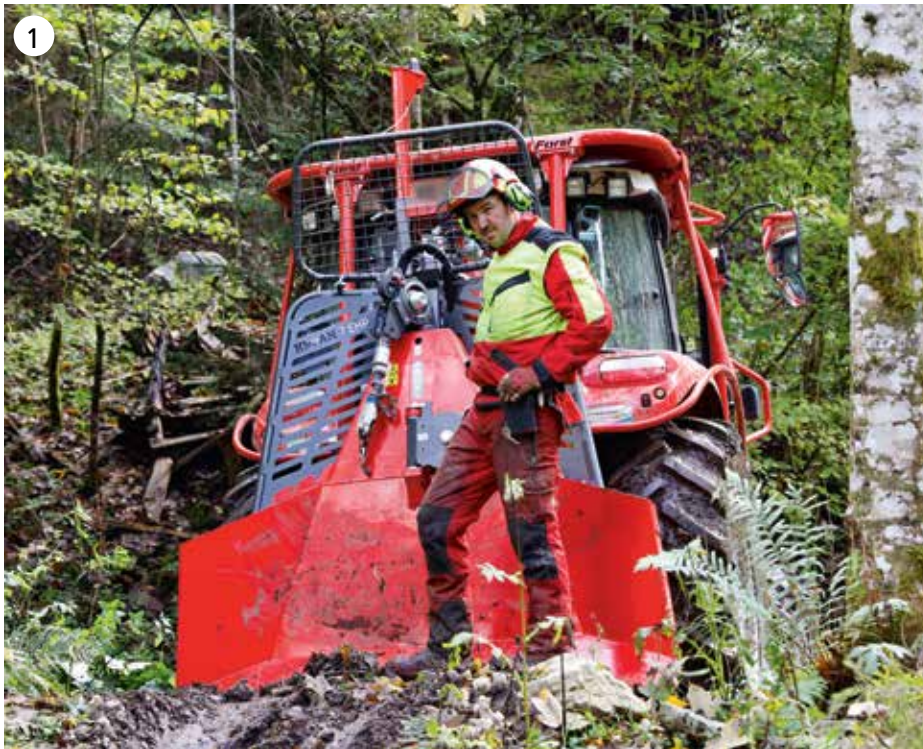
1) Die Krpan 7EHP ist im Test mit zwei Endabschaltern, Kippstopp und guter Standfestigkeit als sicher erschienen. 2) Der patentierte Endschalter am unteren Seileinlauf funktioniert sehr gut. 3) Der Terra-Funk ist einfach und hat eine Kippstopp-Funktion im Empfänger verbaut.
