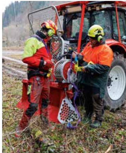
Mit der BP3 wird großteils im 2-Mann-Verfahren als Rundum-Betrieb gearbeitet.
