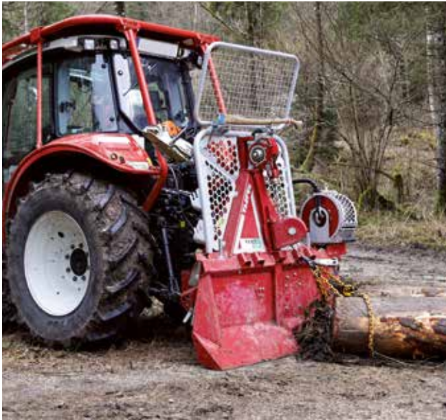
Die Begrenzung des seitlichen Zuzugs auf rund 30° beiderseits schränkt den Betrieb der Seilwinde ein.
