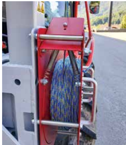
Die federbelasteten Wippe zur Schlackseil-Überwachung sollte noch verbessert werden.
