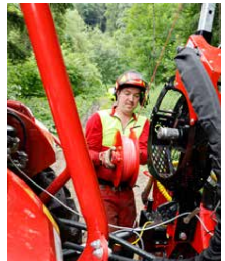
Die Trommel und der Mastkopf lassen sich abnehmen, sind aber schwer erreichbar.
