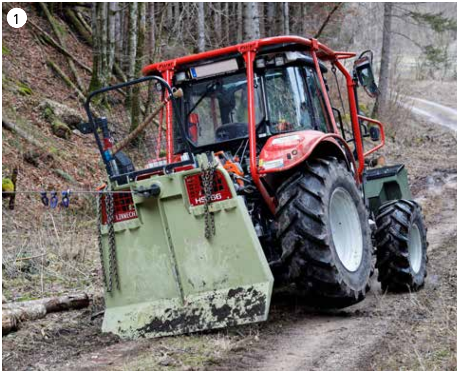
1) Die Holzkecht HS66 ist serienmäßig mit einem gut funktionierenden Anti-Kipp-System ausgestattet. 2) Die Holzkecht-Winde machte beim Poltern auch ohne verstellbares Schild eine gute Figur. 3) Autec-Funk mit stabiler Signalübertragung auch bei über 100 m Reichweite.
