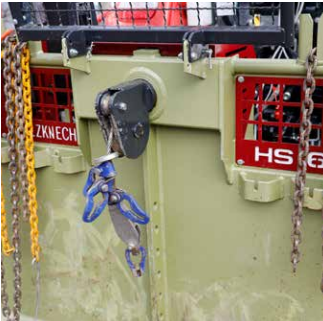
Viele praktikable Kettenfallen und zwei Staufächer mit Deckel zeichnen diese Winde aus.
