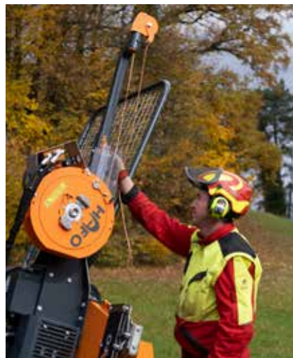
Der Mast der HAFO Hilfswinde lässt sich in fünf Höhenstufen montieren.
