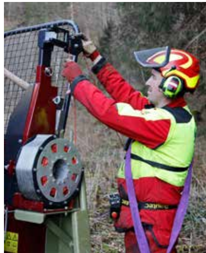
Der Mast der RS500 Mast lässt sich in der Höhe einfach verstellen.
