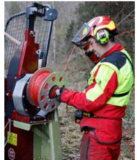
Das Entnehmen des Seils aus dem Mast und das Abnehmen der Seiltrommel sind einfach.
