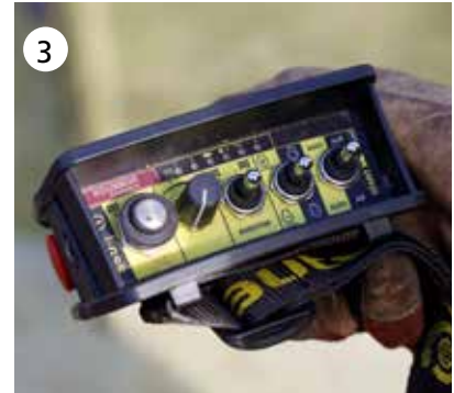
1) Die Holzkecht HS66 ist serienmäßig mit einem gut funktionierenden Anti-Kipp-System ausgestattet. 2) Die Holzkecht-Winde machte beim Poltern auch ohne verstellbares Schild eine gute Figur. 3) Autec-Funk mit stabiler Signalübertragung auch bei über 100 m Reichweite.
