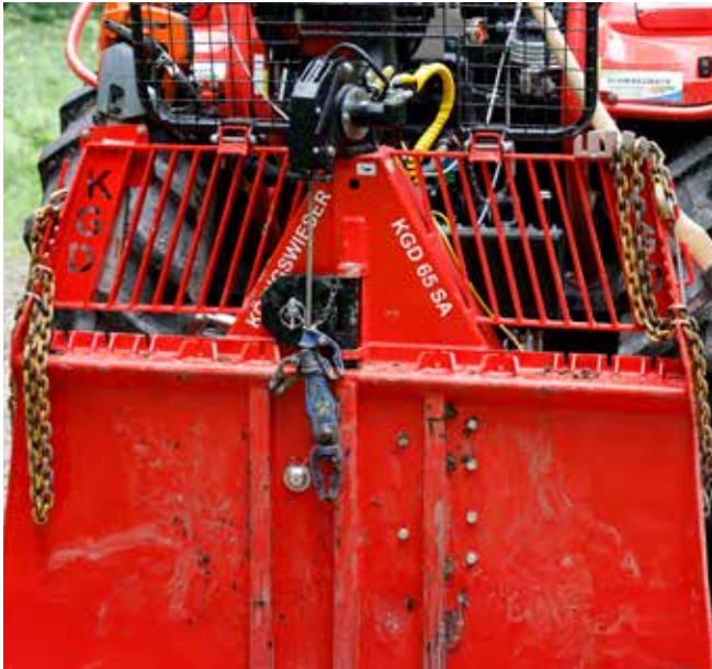
Viele Kettenfallen und Dorne zum Aufhängen von Ketten sowie die serienmäßige untere Umlenkrolle erleichtern die Arbeit.
