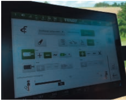
Einstellung von Anbaugeräteparametern und der «Implement Slope Compensation» mittels Schieber in «FendtOne».
