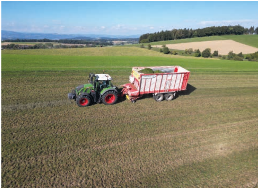
Laden mit aktivem Lenksystem in starker Hanglage.
