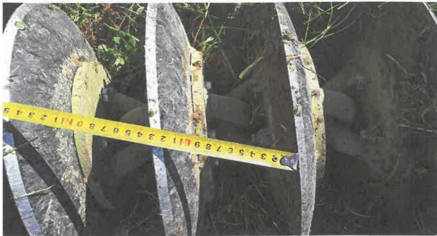
Der Abstand zwischen den Scheiben ist deutlich geringer als bei der klassischen Scheibenegge.
