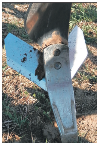
Beim PTA-beschichteten Schar sind die besonders verschleißgefährdete Spitze und Flanke mit einer wolframkarbidreichen Legierung geschützt.
