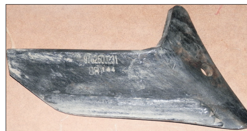
Beschichtungen mittels Fülldrahtschweißung schützen den Flügel am besten auf der Unterseite.
