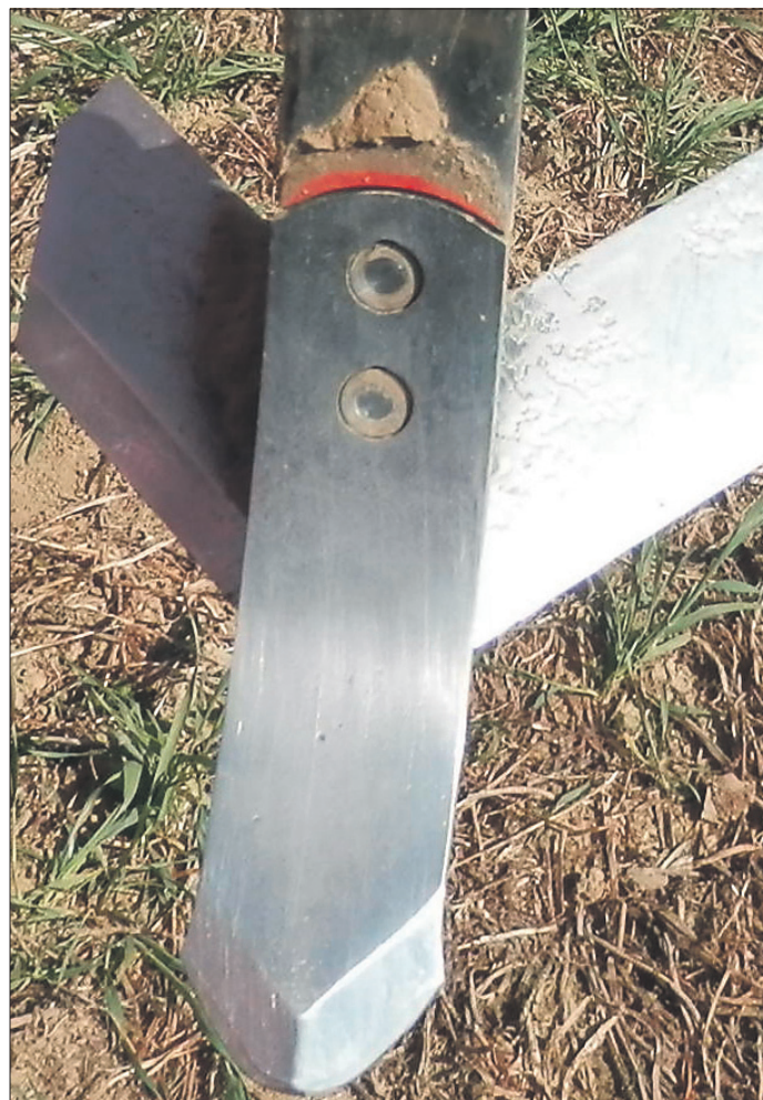
Die Erhöhung der Härte von Standardscharen (l.) ist begrenzt, da sie ansonsten zu spröde werden. Den besten Verschleißschutz bieten aufgelötete Hartmetallspitzen (r.). Sie sind allerdings auch am teuersten.
