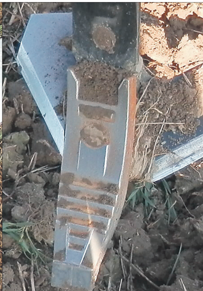
Die Erhöhung der Härte von Standardscharen (l.) ist begrenzt, da sie ansonsten zu spröde werden. Den besten Verschleißschutz bieten aufgelötete Hartmetallspitzen (r.). Sie sind allerdings auch am teuersten.
