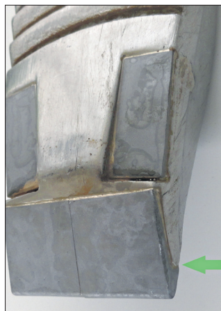
Die abgewinkelte Form (siehe Pfeil) stellt sicher, dass die Hartmetallspitze bei Berührung mit Steinen nicht wegbriecht.
