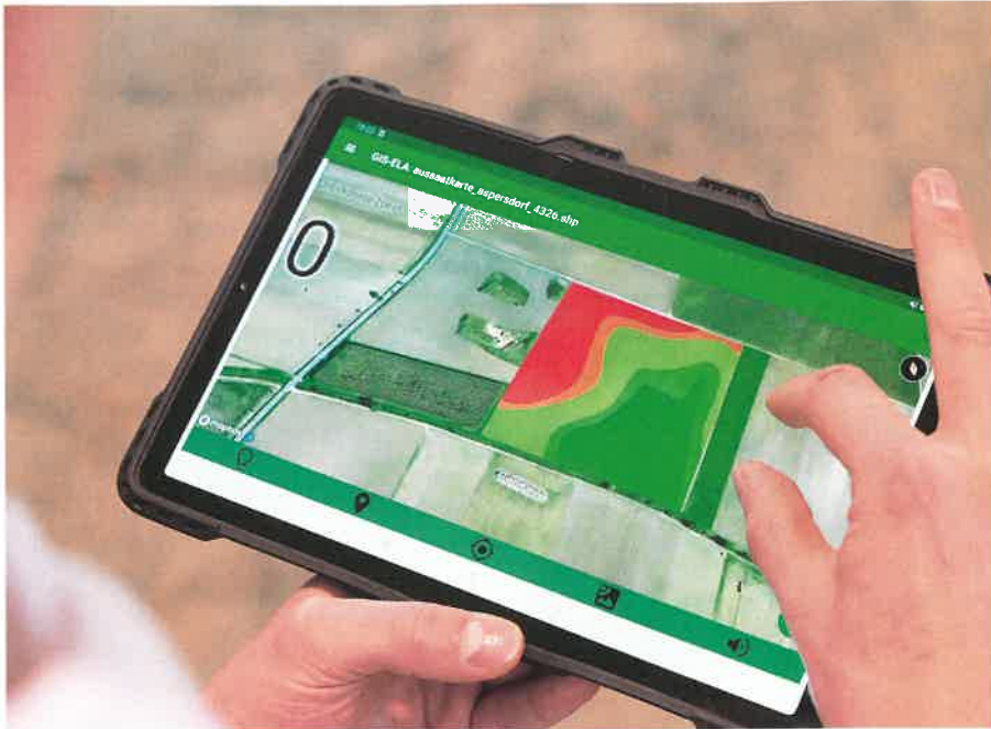
Mit der App «GIS-ELA» ist eine teilflächenspezifische Ausbringung auch ohne jegliche Zusatzausstattung am Traktor oder am Düngerstreuer möglich.
