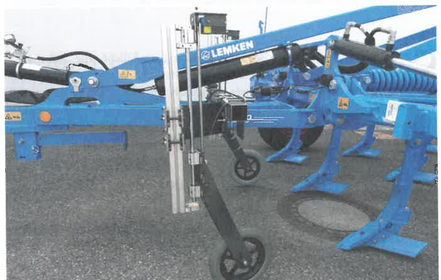
Tasträder überprüfen das Einhalten der gewünschten Arbeitstiefe.
