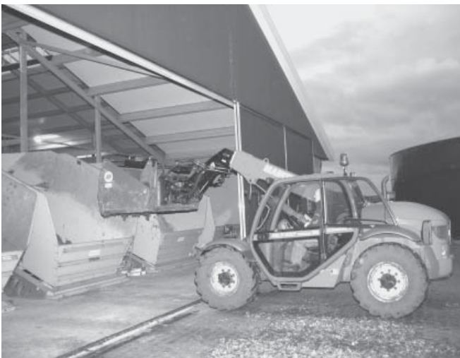
Abb. 3. Beschickung der Vorratsbehälter eines automatischen Fütterungssystems
