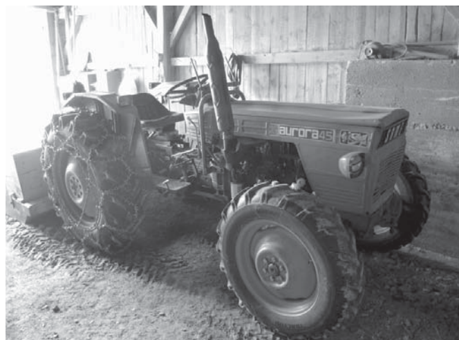
Abb. 7. Fehlende Überrollschutzeinrichtung, Same Aurora 45 – gute 30 Jahre auf dem Buckel. (Eine Überrollschutzeinrichtung bzw. Umsturzsicherheitsvorrichtung ist eine Einrichtung, die verhindert, dass der Traktor beim Umsturz mehr als eine Vierteldrehung kippt.)
