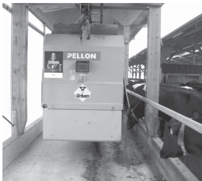
Abb. 2. Schienengeführtes Fütterungssystem bei der Futtervorlage (Pellon)
