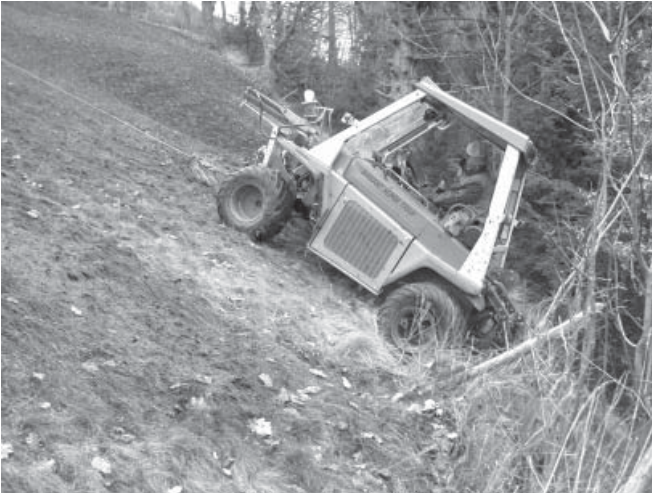
Abb. 4. Der Zweiachsmäher wird mit einem Seil geborgen
