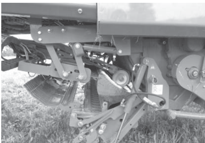
Abb. 1. Automatische Schleifeinrichtung «autocut» am Ladewagen. Räum- und Schneidwerk sind ausgeschwenkt und die Schleifeinrichtung befindet sich in Arbeitsposition.
