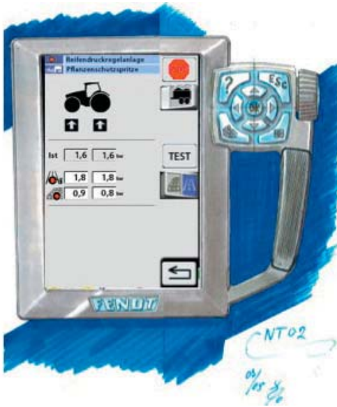
Abb. 3. Bedienung über das Schlepperterminal
