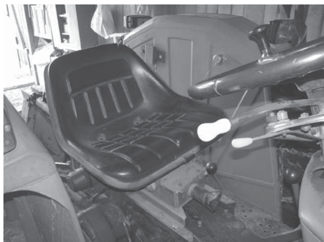
Abb. 8. Fehlendes Fahrerrückhaltesystem, Same Aurora 45 – kein Fahrerrückhaltesystem. (Ein Fahrerrückhaltesystem ist eine Einrichtung, die bewirkt, dass der Fahrer beim Umsturz des Traktors auf dem Fahrersitz gehalten wird und nicht zwischen Teilen des Traktors und dem Boden eingeklemmt werden kann.)
