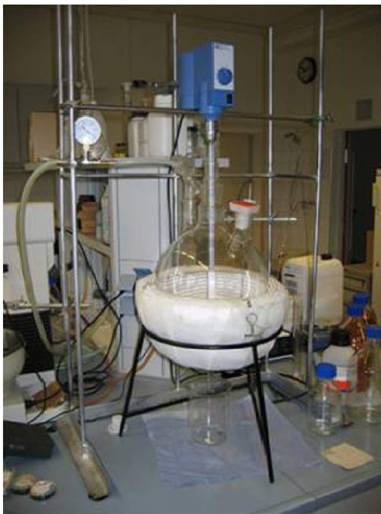
Abbildung 25: 10 Liter Laborumesterungsanlage FJ-BLT
