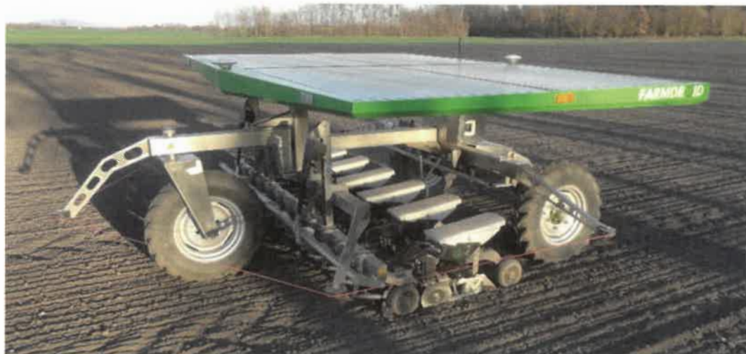
Bild 1: Das um den Farmdroid gespannte Not-Stopp-Sicherheitsseil stoppt ihn bei Berührung mit Hindernissen
