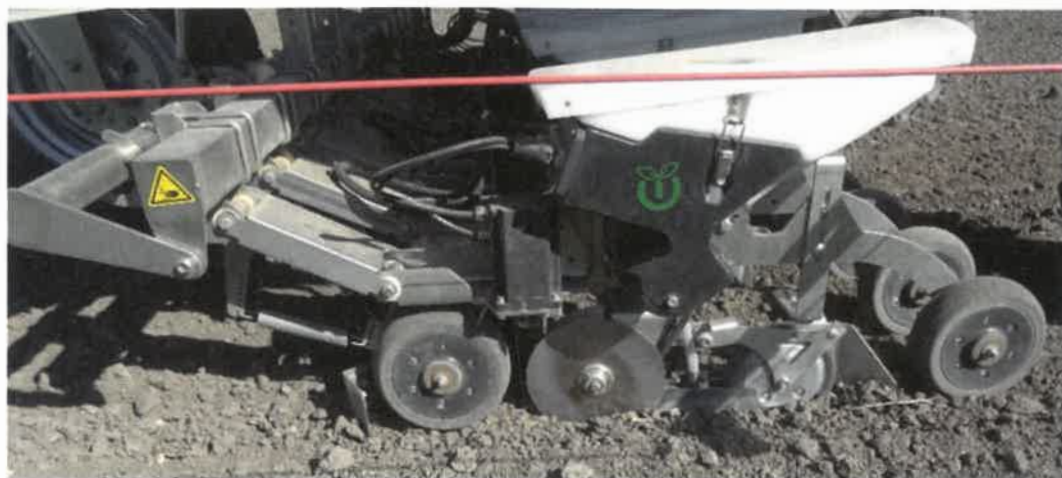
Bild 2: In der Säeinheit fallen die mechanisch vereinzelt Samen in das rund 3 cm über dem Boden liegende Säventil, das bei Erreichen der Ablageposition öffnet
