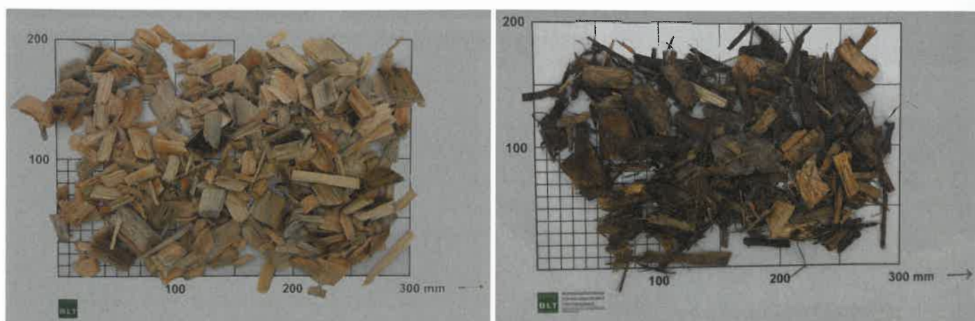
Abbildung 1: Vergleich unterschiedlicher Brennstoffqualitäten. Auf der linken Seite sind Hackschnitzel mit sehr guter Qualität abgebildet. Ein niedriger Rinden- und Feinanteil sowie Wassergehalt führen in weiterer Folge zu geringeren Emissionen. Die rechte Seite zeigt Hackschnitzel von schlechterer Qualität. Der hohe Anteil an Rinde und Feinanteil sowie sonstigen Verunreinigungen haben einen hohen Aschegehalt und Staubemissionen zur Folge.
