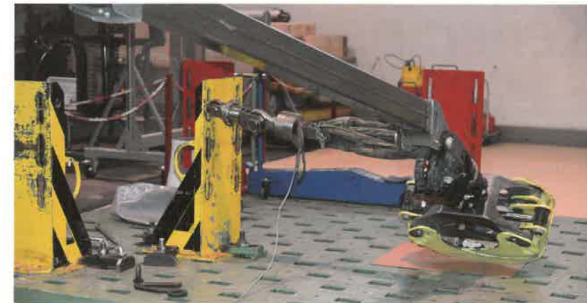
Mithilfe dieser Vorrichtung wurde im Test das Kranschwenkmoment der zehn Forstkranhänger ermittelt.
