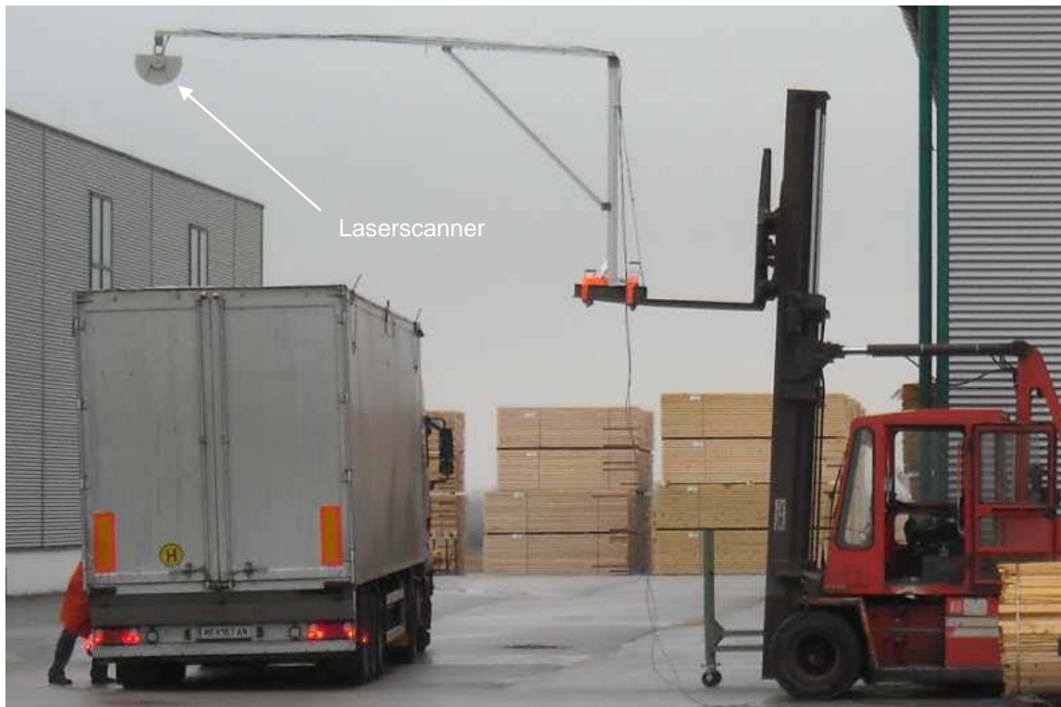
Abbildung 7: Messaufbau zur Volumsbestimmung eines mit Hackgut beladen LKW
