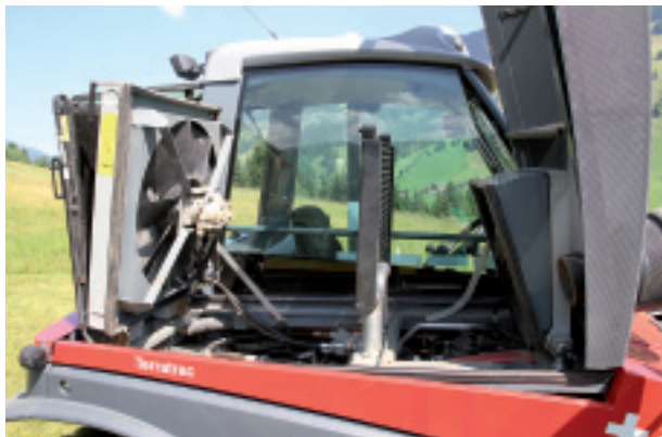
109 PS starker VM-Motor mit guter Zugänglichkeit für Wartungs- und Reinigungsarbeiten.
