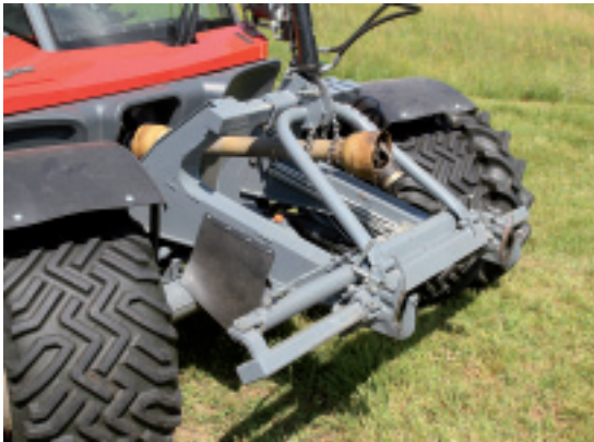
Vorderer Anbaureaum: durchgehende Hubkraft 1.900 kg, Seitenverschub serienmäßig, 540 oder 1.000 Zapfwelenumdrehungen.
