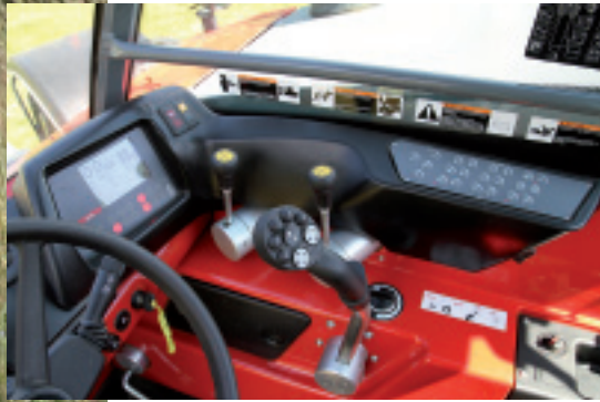
Modernes Bedienkonzept: Einhand-Steuerung mit multifunktionalem Fahrhebel, Folientastatur und digitales Display.
