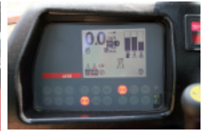
Modernes Bedienkonzept: Einhand-Steuerung mit multifunktionalem Fahrhebel, Folientastatur und digitales Display.
