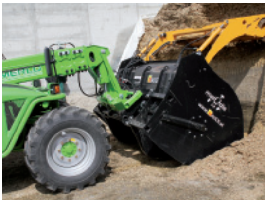
Beim Einsatz z.B. von Futtermittelschaufeln muss eine leistungsstarke Arbeitshydraulik bereitstehen.
