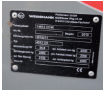
Ordnungsgemäße Kennzeichnung durch Typenschilder am Lader und in der Kabine informieren über die Einhaltung von Richtlinien.
