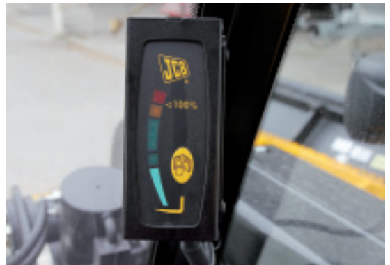
Lastanzeigen geben dem Fahrer beim Heben und Senken Informationen über die Standsicherheit der Maschine.
