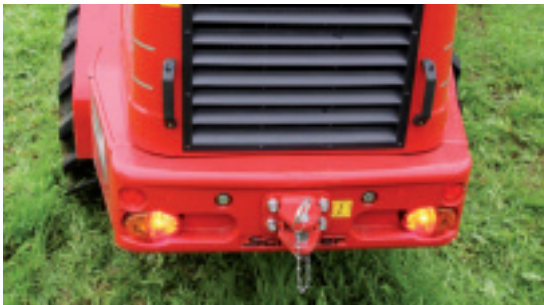
Sofern Anhänger gezogen werden, ist die Ausstattung mit einer Abschleppöse unzureichend.
