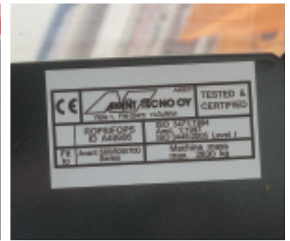
Ordnungsgemäße Kennzeichnung durch Typenschilder am Lader und in der Kabine informieren über die Einhaltung von Richtlinien.
