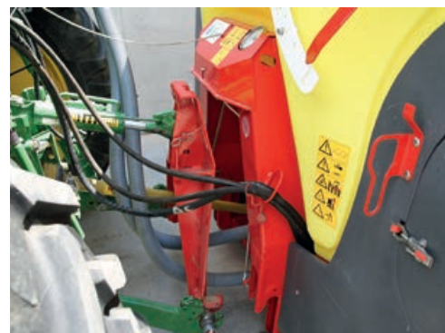
Schnellkuppelvorrichtung für sicheren An- und Abbau.
