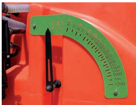
Gut sichtbare Füllstandsanzeige für Behälterinhalt.
