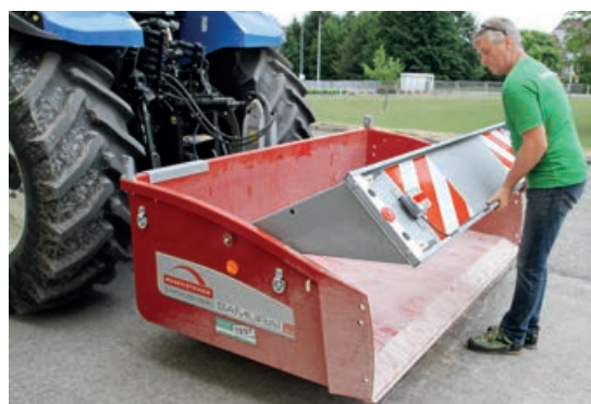
Die schwenkbare Rückwand hat sich in der Praxis gut bewährt und ist heute Stand der Technik.
