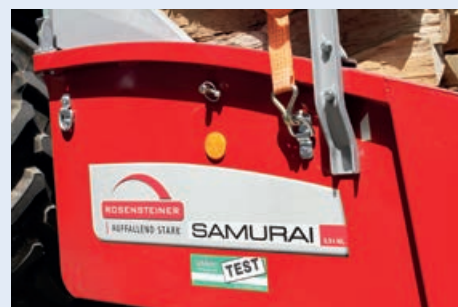
Rosensteiner: Bewegliche Zurrhaken an den Seitenwänden.
