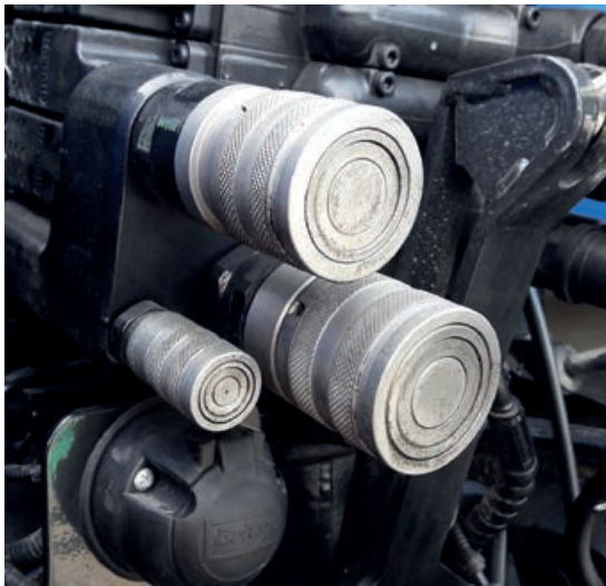
Die Load-Sensing-Kupplungen weisen drei unterschiedliche Größen auf. Sie können auch als Steckkupplungen mit Muffen oder Steckern ausgeführt sein.
