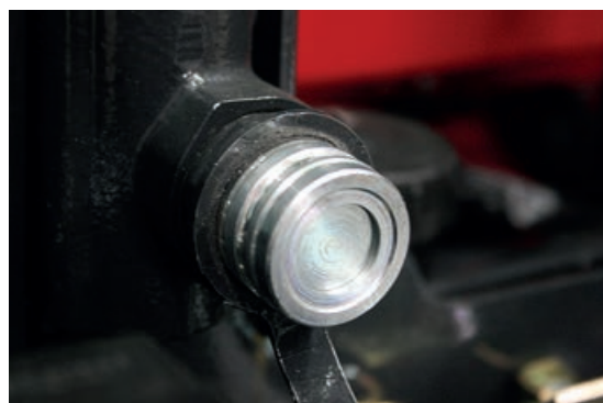
Hydraulische Anhängerbremsanlage mit traktorseitigem ISO 5676 Stecker.
