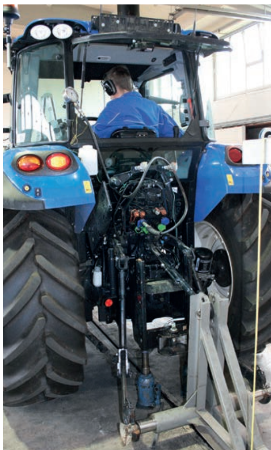
Für die LANDWIRT-Praxistests misst die BLT Wieselburg auf ihrem Prüfstand unter anderem die Hydraulikleistung sowie Hubkraft der Testkandidaten.
