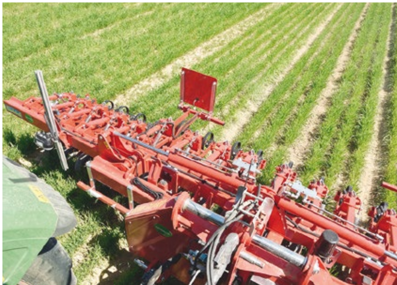
Am hydraulischen Parallelverschieberahmen können ohne großen Umbauaufwand verschiedene Geräte angebaut werden.
