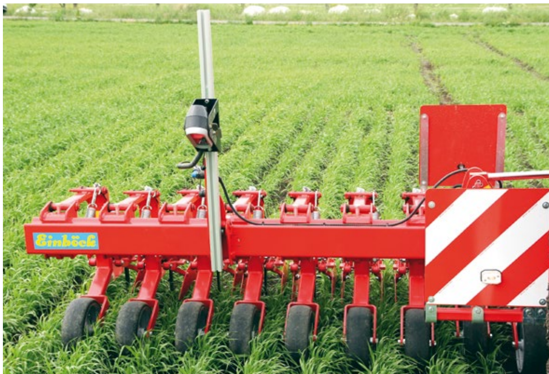
Die Kamera erfasst die grüne Farbe der Pflanzenreihe und/oder die Wuchshöhe der Kulturpflanzen.
