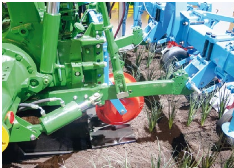
Hydraulische Unterlenker steuern das Hackgerät, ein Zwischenrahmen ist nicht nötig.
