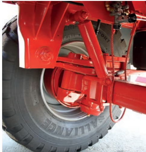
Trommelbremsen sind häufig an Geräten mit eigener Achse zu finden.
