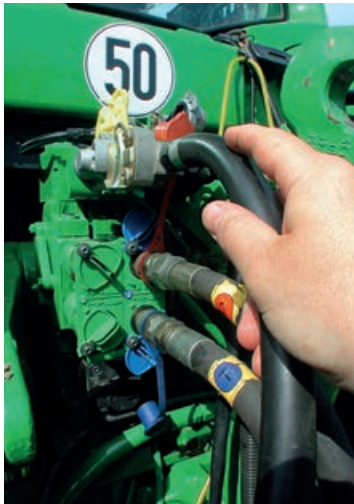
Bei angehängten Maschinen haben sich je nach Region pneumatische oder hydraulische Zweileitungs-bremsen etabliert.
