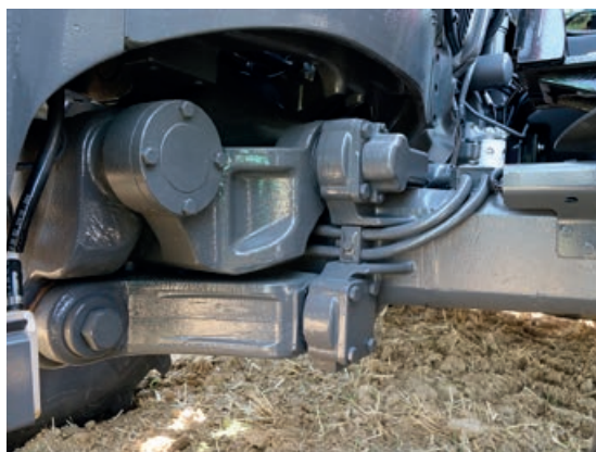
Die gefederte Vorderachse bereitet eine gute Vorarbeit für die gefederte Kabine.
