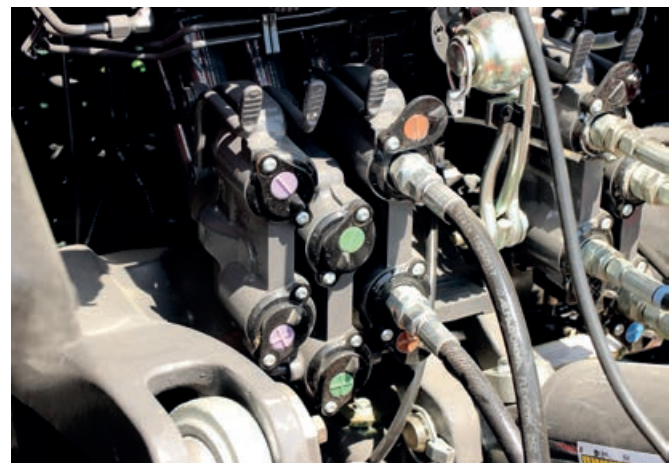
Die Hydraulikanschlüsse verfügen über Entlastungshebel.
