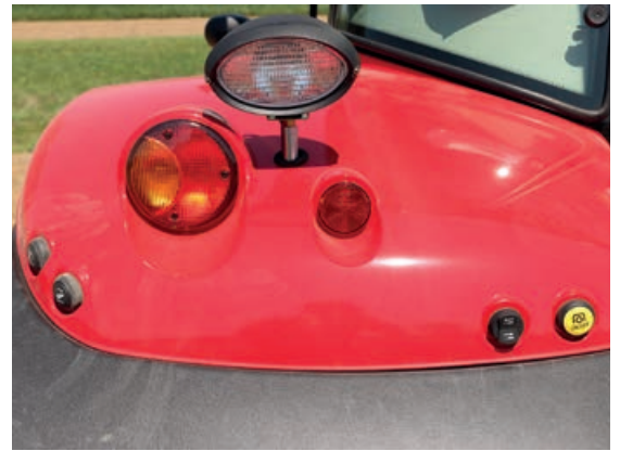
Am linken Kotflügel sind Hubwerk, Zapfwelle und ein frei wählbares Steuergerät bedienbar.
